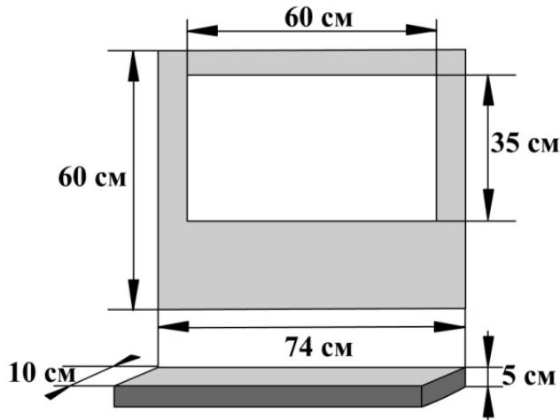
Чертеж ширмы приведен на рисунке слева. Вертикальная часть ширмы с окошком изготавливается из тонкой фанеры или толстого картона и с помощью шурупов-саморезов привинчивается к подставке в 3-4 местах. Подставка должна быть спереди, чтобы не мешать актерам управлять куклами.
